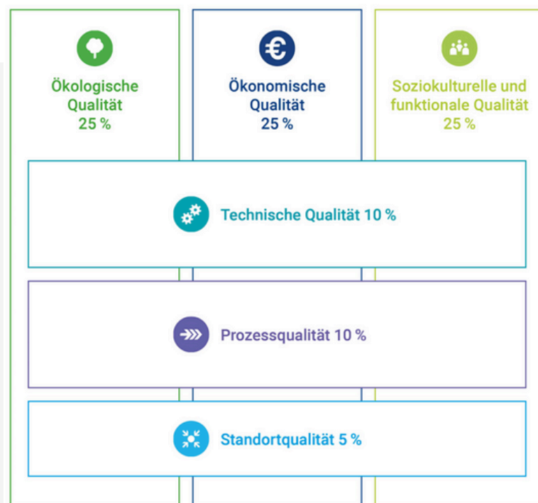
Abbildung 1: Grundstruktur des DGNB Systems – Neubau Gebäude Version 2023 © DGNB
