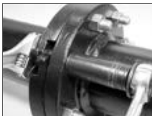
Séquence de serrage pour 4 boulons
