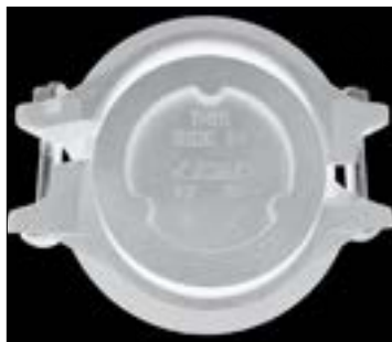
MAUVAIS MONTAGE (MAUVAISE EXTRÉMITÉ DU CAPUCHON D'EXTRÉMITÉ VERS L'EXTÉRIEUR – LA QUINCAILLERIE NE POURRA PAS ÊTRE SERRÉE POUR AMENER LES PATINS DE BOULONS À FAIRE CONTACT MÉTAL SUR MÉTAL)
