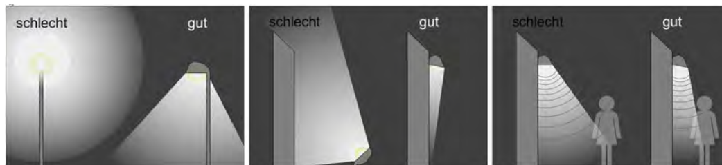
Beleuchtungsbeispiele (Quelle: Büro Faerber nach Przygoda)
