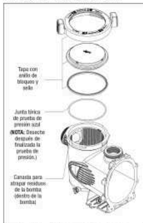
Figura 15. Vista ampliada con junta tórica de prueba de presión azul (modelos de bomba VSSHP únicamente)
