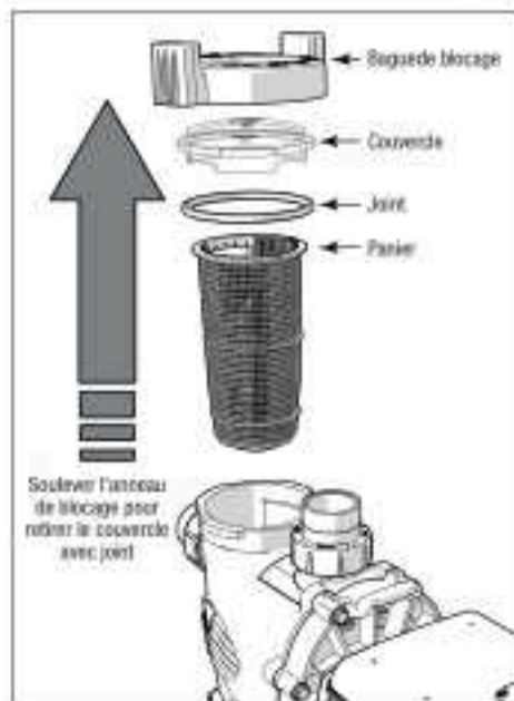
Figure 18. Retrait du couvercle de la pompe
