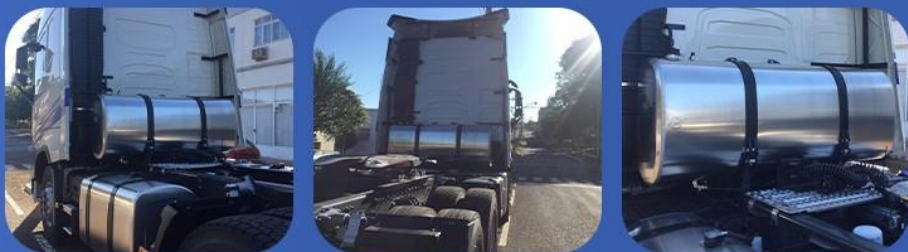
Tanque Plataforma Inox 304 Ø690mm 550L Diesel + 150L Arla Volvo
