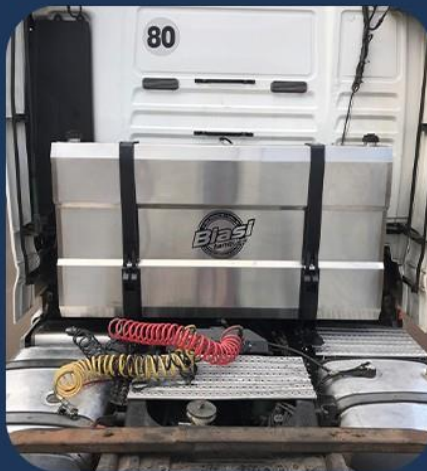
Tanque para diesel para caminhões com entre-eixos menores e com pouco espaço para manobra.
