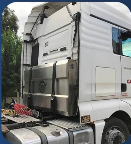
Tanque para diesel para caminhões com entre-eixos menores e com pouco espaço para manobra.
