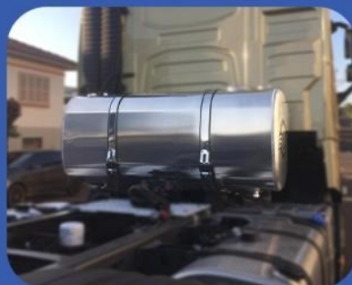
Diesel + Óleo Hidráulico
