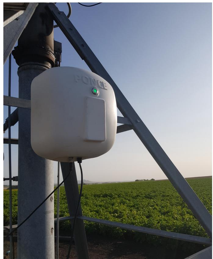
La solución de Ponce también permite notificar anomalías que requieren una inspección adicional. Además, los dispositivos reportan las horas de uso, milímetros aplicados, caudal y la medición de la lluvia. Estos datos permiten a los productores ejecutar planes de riego precisos. Pueden así monitorear la cantidad de agua que maneja el sistema de riego, así como el movimiento y la posición del equipo de riego. "Nuestra solución brinda a los productores la
