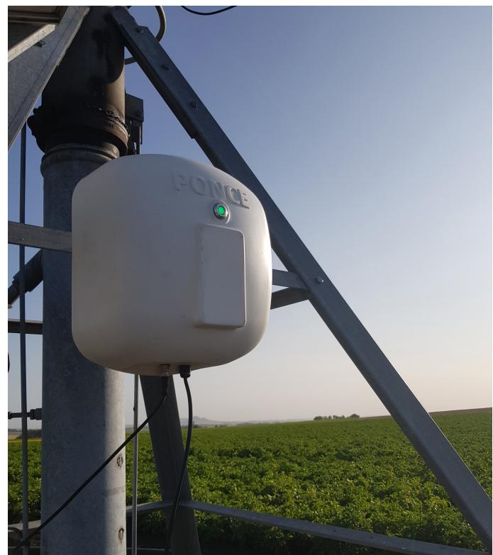
A solução da Ponce também permite que os agricultores recebam notificações de anomalias que exigem mais inspeção. Pontos de dados adicionais relatados incluem horas de uso, consumo de água, vazão e medição de precipitação. Esses pontos de dados permitem que os agricultores recebam cronogramas de irrigação ideais. Os agricultores podem monitorar a quantidade de água dispensada pelo sistema de irrigação, bem como o movimento e a posição do equipamento de irrigação.
