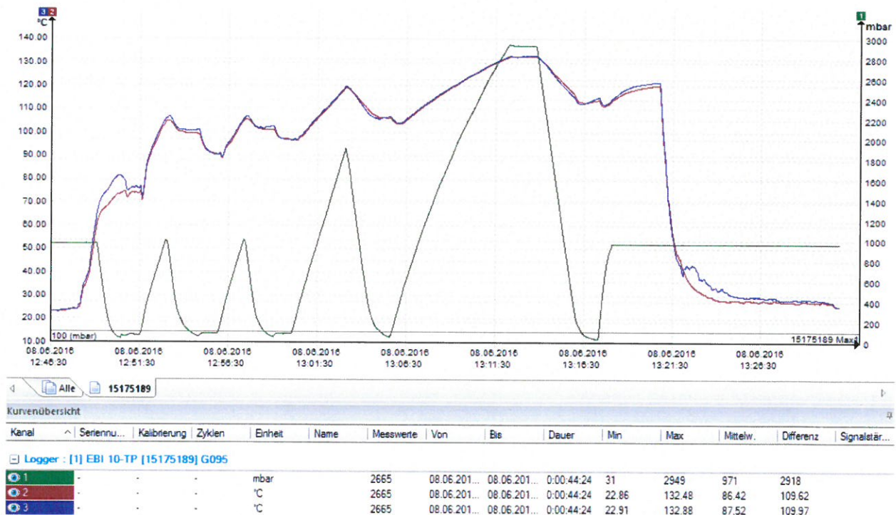
Abbildung 6: Loggerdiagramm eines Sterilisationszyklus
