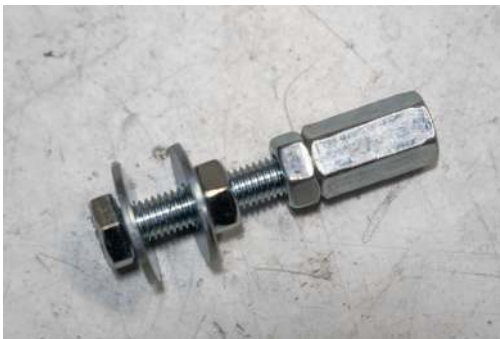
▲ Figure 67. M8 X 50 bolt.
