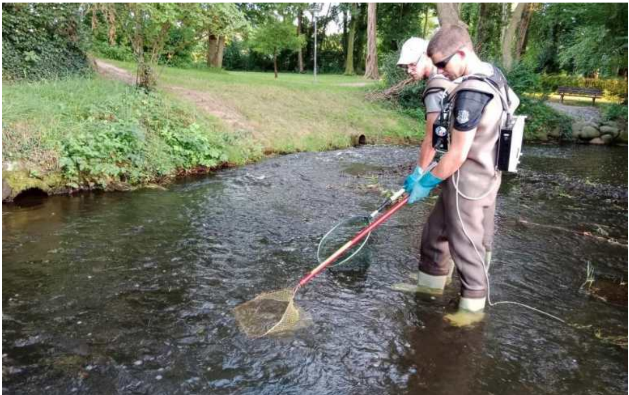
Abb. 86: In den kleineren Fließgewässern obere Oste, Aue-Mehde und Bade wurde der Fischbestand mit tragbaren Elektrofischfanggeräten ermittelt; hier: Joschka Stemmann und Martin Demmer von SFV Sittensen, die uns mit zahlreichen Befischungen unterstützt haben (Foto: Ralf Gerken / AVN).
