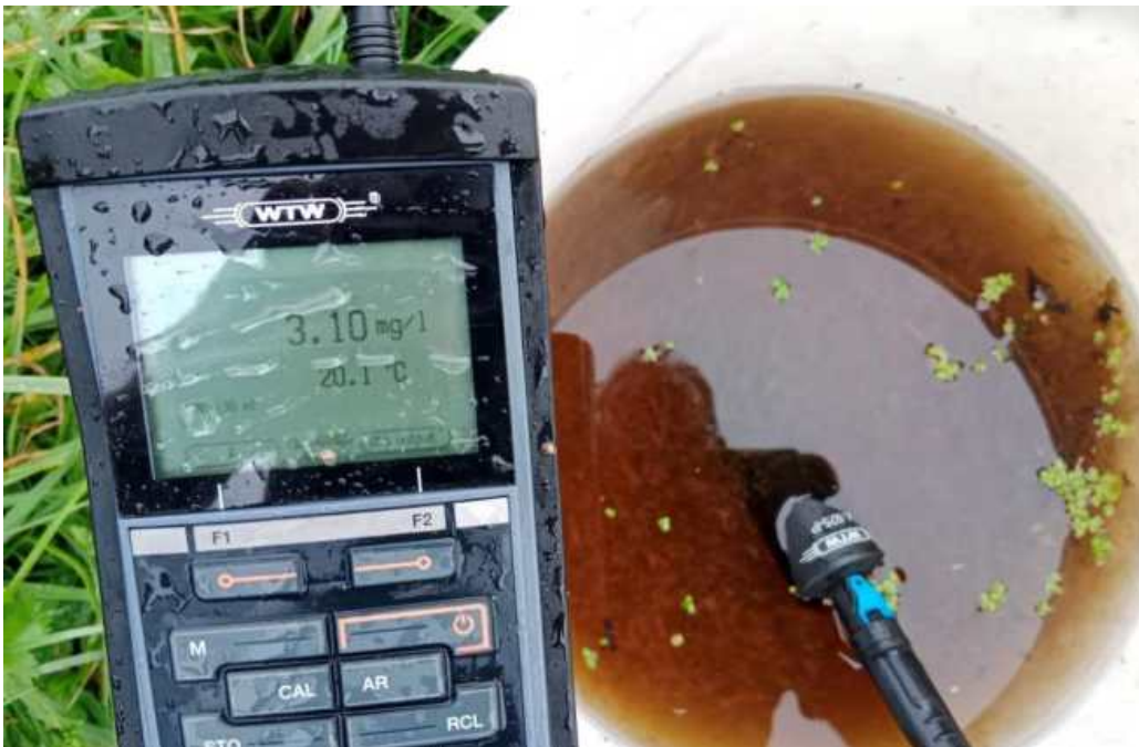
Abb.5: Die Sauerstoffmessungen wurden mit einem professionellen Messgerät mit optischen Sauerstoffsensor durchgeführt. Zur Absicherung der Messgenauigkeit wurden die Messwerte der verwendeten Geräte mehrfach mit baugleichen Geräten verifiziert (Foto: Ralf Gerken / AVN).
