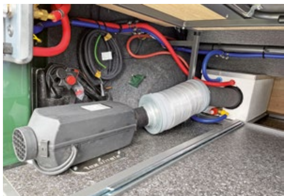
Das Warmduscher-Set mit neun Litern Volumen wird bei laufender Dieselheizung von warmer Luft gespeist, außerhalb der Heizperioden sorgt ein 12-Volt-Heizstab für warmes Wasser.
