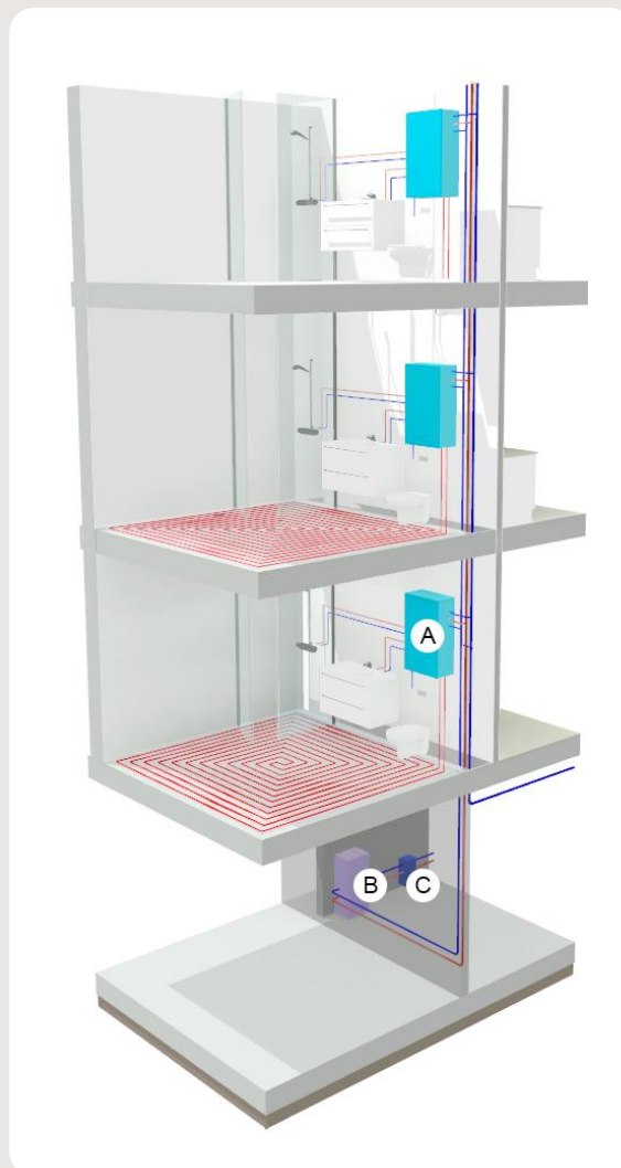
Figur 1: Snitt boligbygg med plassering av ulike komponenter. Skissert 3-rørsløsning er tilrettelagt for individuell måling fra Lunera Energi
