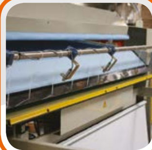
Scarico automatico con pacchi di capi stirati fino a 50 cm. Automatic unloader till ironed packs of garments up to 50 cm
