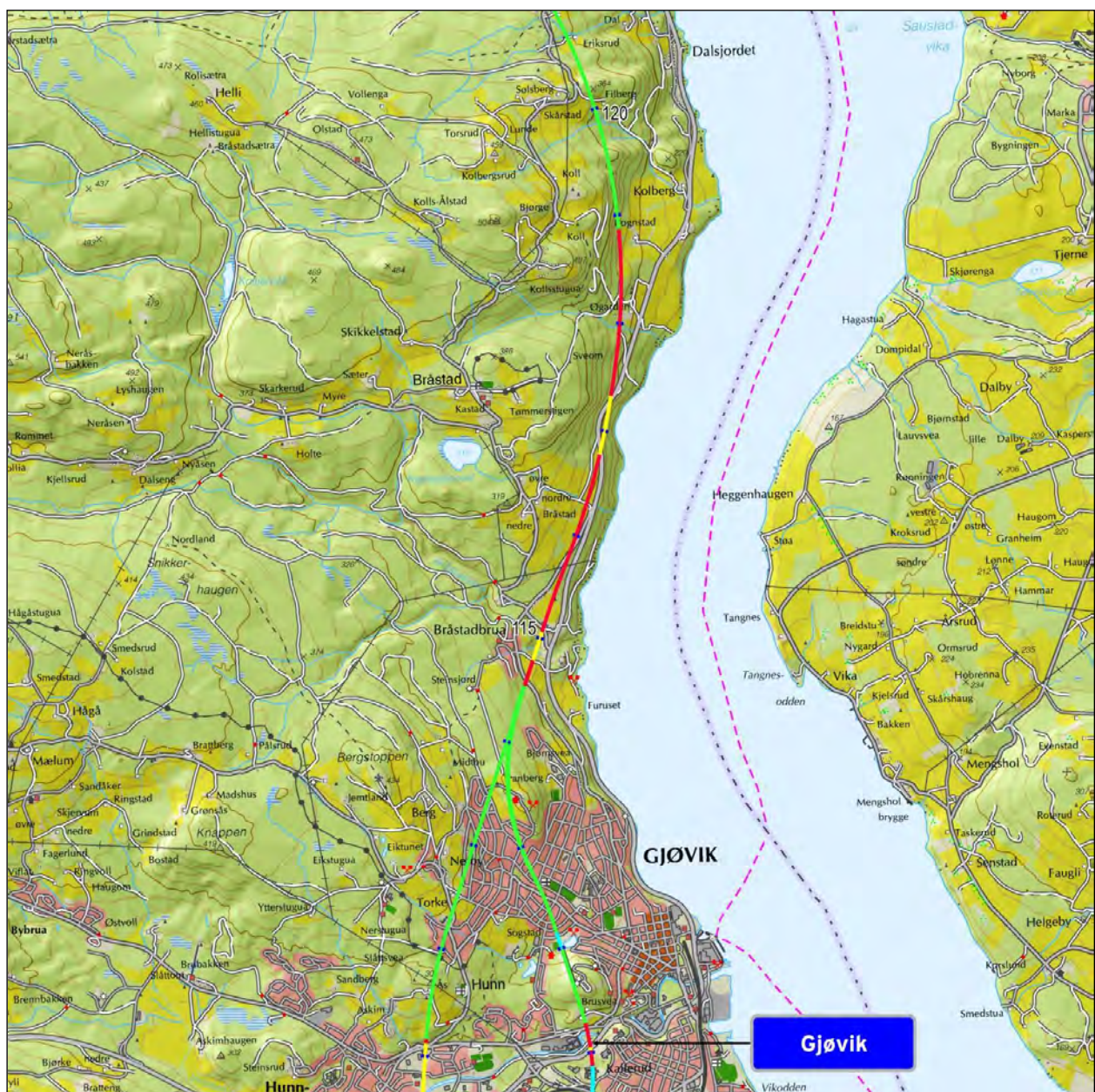
Detaljkart 10: Fra Gjøvik til Dalsjordet. © Norsk Bane AS. Dagstrekninger er inntegnet i rødt, broer i gult, tunneler i grønt og kulverter i lyseblått. Kilometerangivelsene viser distansen fra Oslo S. Kartutsnittet er 10 km x 10 km.
