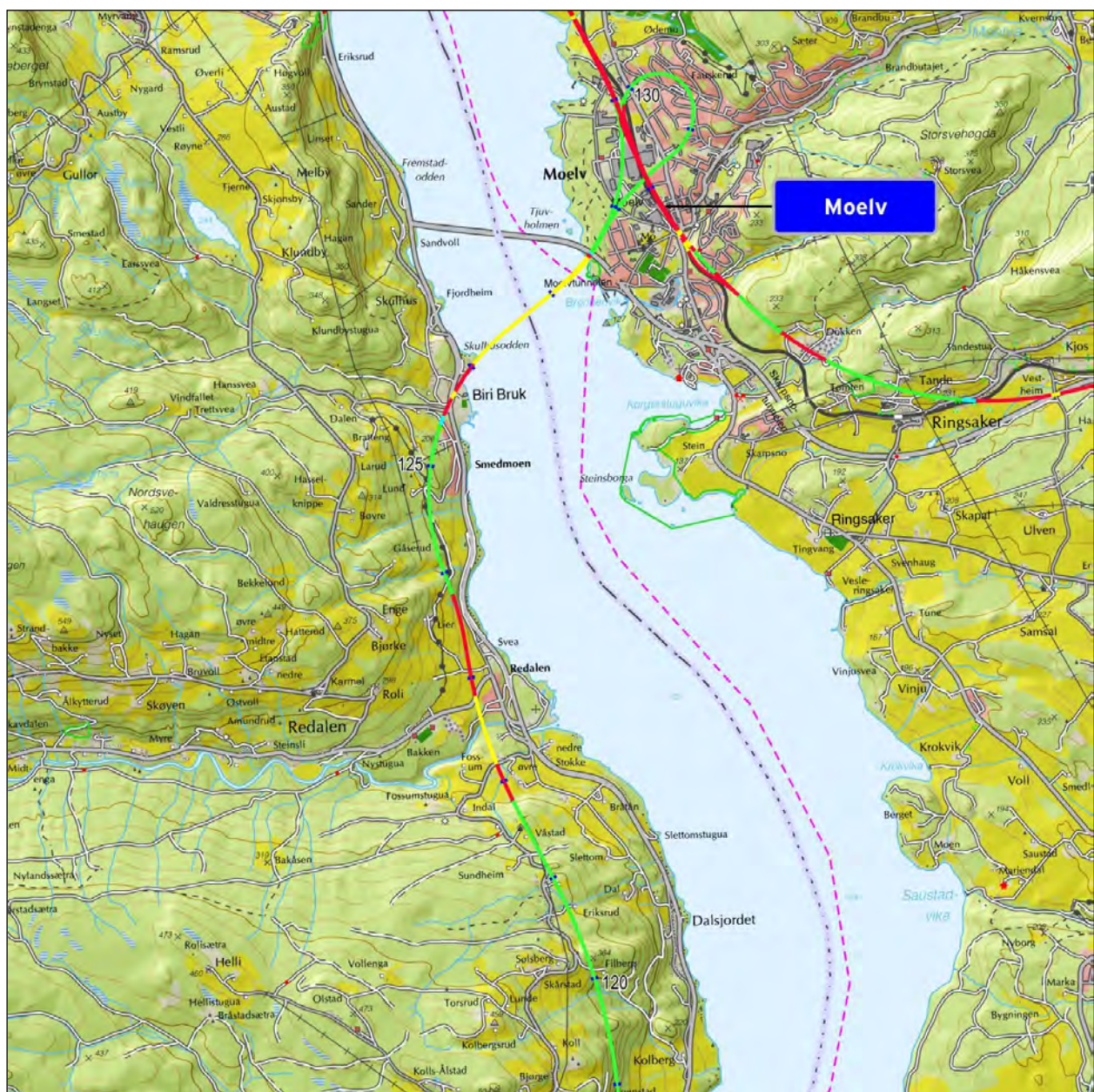
Detaljkart 11: Fra Dalsjordet til Moelv. © Norsk Bane AS. Dagstrekninger er inntegnet i rødt, broer i gult, tunneler i grønt og kulverter i lyseblått. Kilometerangivelsene viser distansen fra Oslo S. Kartutsnittet er 10 km x 10 km.
