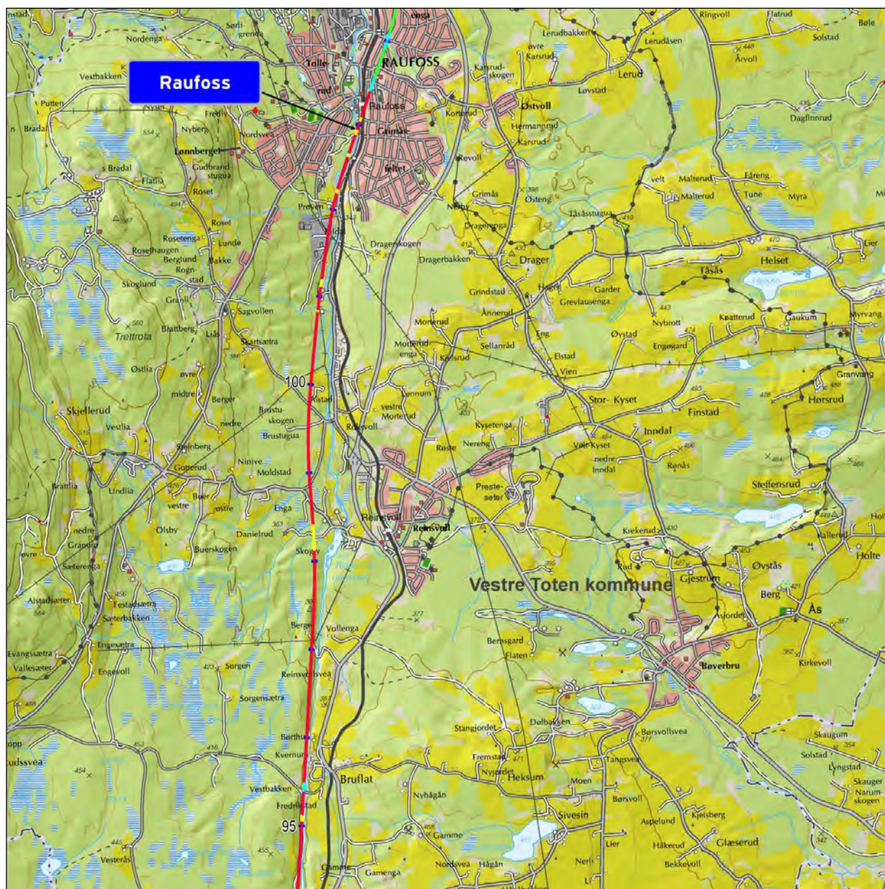
Detaljkart 8: Fra Bruflat til Raufoss. © Norsk Bane AS. Dagstrekkninger er inntegnet i rødt, broer i gult, tunneler i grønt og kulverter i lyseblått. Kilometerangivelsene viser distansen fra Oslo S. Kartutsnittet er 10 km x 10 km.
