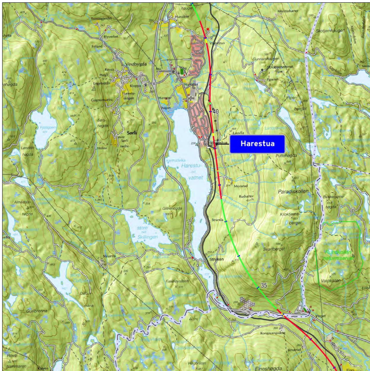
Detaljkart 1: Fra Nittedal grense til Viubråten. © Norsk Bane AS. Dagstrekninger er inntegnet i rødt, broer i gult og tunneler i grønt. Kilometerangivelsene (blå merker) viser distansen fra Oslo S. Kartutsnittet er 10 km x 10 km.
