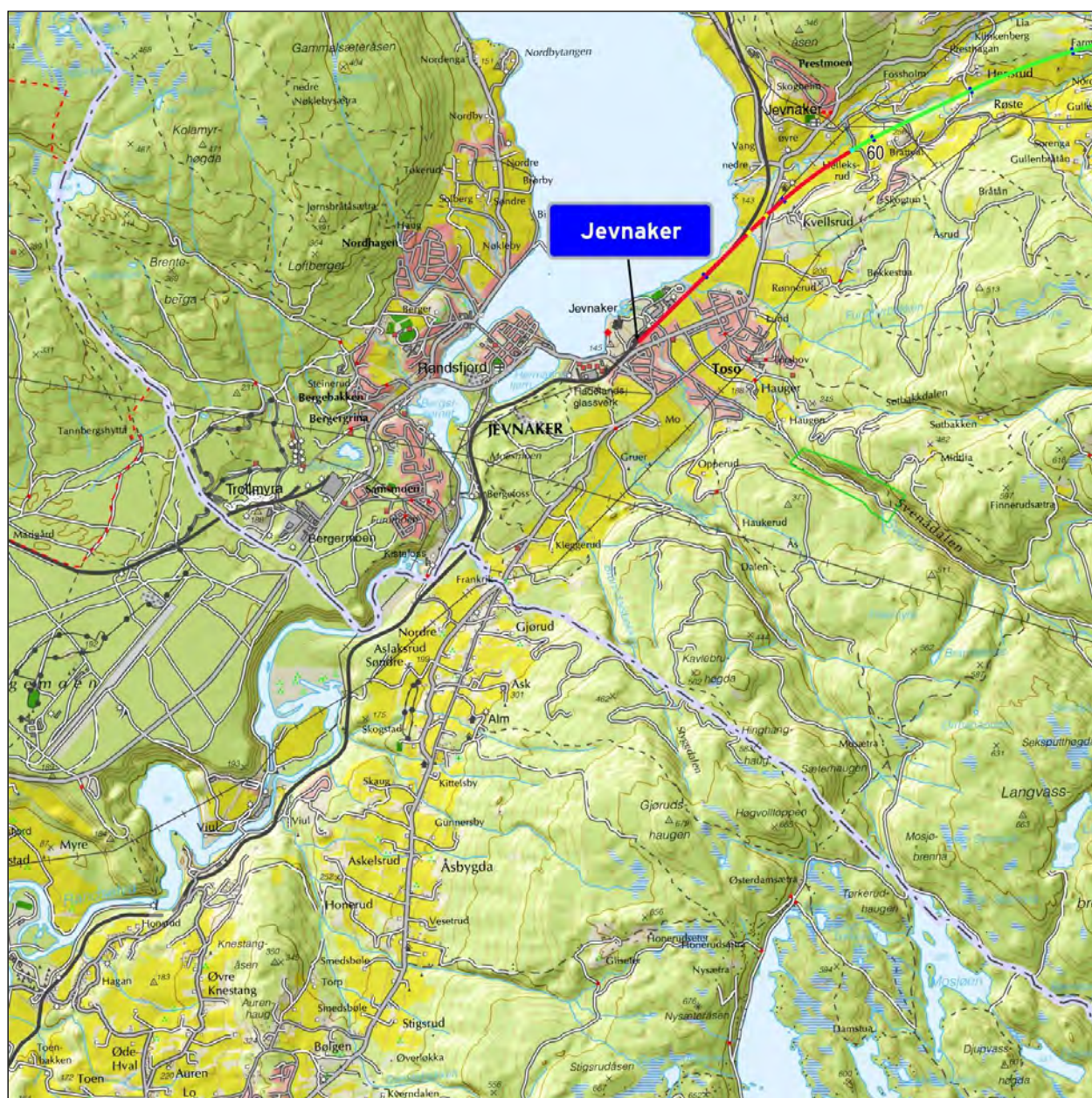
Detaljkart 13: Fra Bratval til Jevnaker. © Norsk Bane AS. Dagstrekninger er inntegnet i rødt, broer i gult, tunneler i grønt og kulverter i lyseblått. Kilometerangivelsene viser distansen fra Oslo S. Kartutsnittet er 10 km x 10 km.
