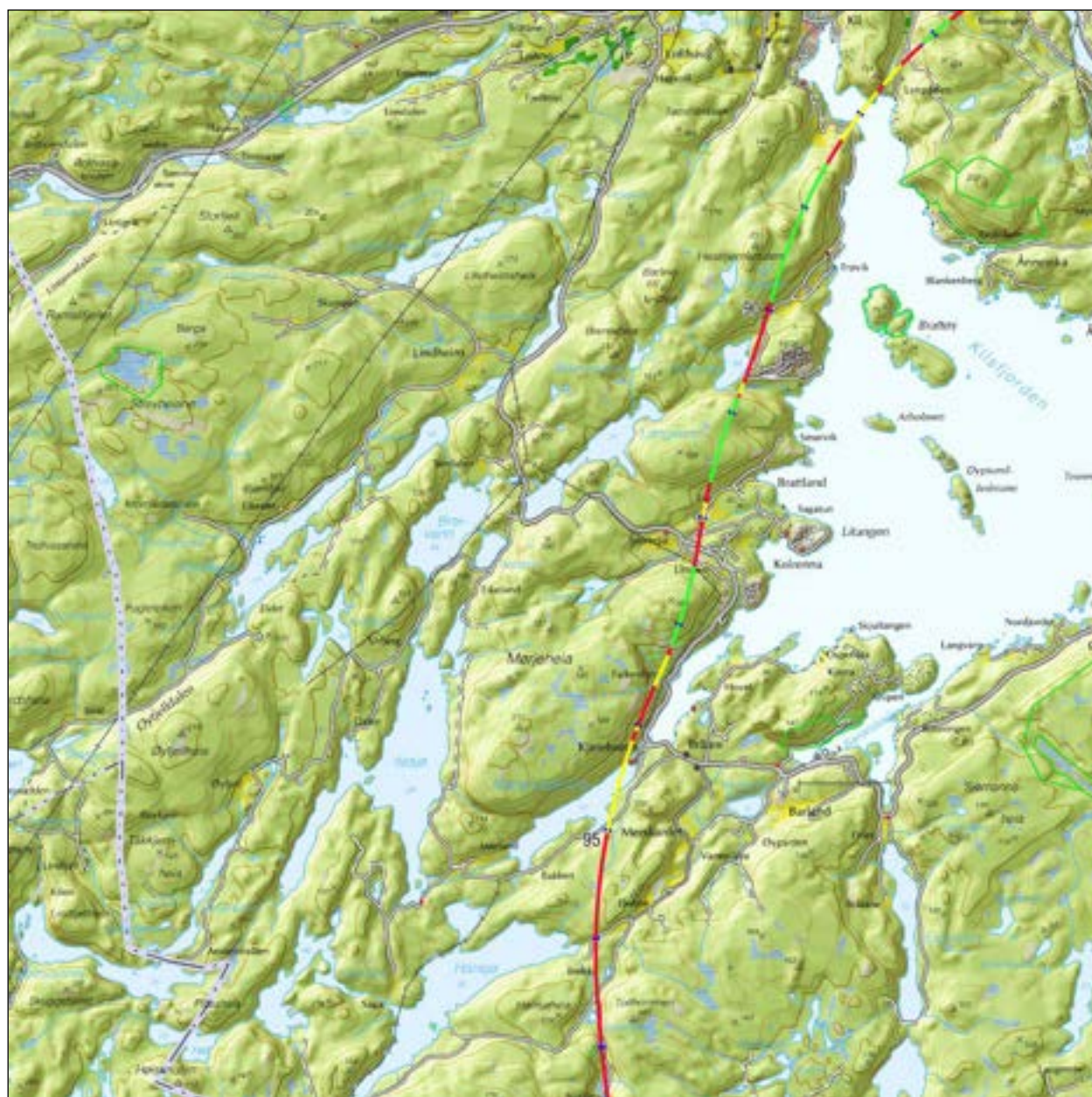
Detalkart 12: Fra Porsgrunn til Risør, anbefalt trasé fra Kilsfjorden til Buslåttdalen. © Norsk Bane AS. Dagstreknin- ger er vist i rødt, broer i gult, overbygg i fiolett og tunneler i grønt. Tunneler og broer på mindre enn 25 meters lengde er ikke inntegnet. Kilometerangivelsene (blå merker) viser distansen fra den nordre enden av forbindelsen mellom Vestlandsbanen og Grenland. Kartutsnittet er på 10 km x 10 km.
