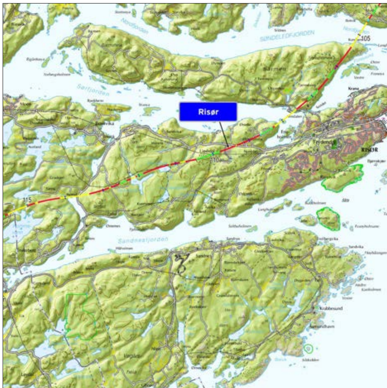
Detaljkart 14: Fra Porsgrunn til Risor, anbefalt trasé fra Søndeledfjorden til Risor stasjon. © Norsk Bane AS. Kartet viser også begynnelsen på en mulig videreføring mot Tvedestrand, men det finnes også flere andre alternativ. Dagstrekninger er vist i rødt, broer i gult, kulverter i cyan og tunneler i grønt. Tunneler og broer på mindre enn 25 meters lengde er ikke inntegnet. Kilometerangivelsene (blå merker) viser distansen fra den nordre enden av forbindelsen mellom Vestlandsbanen og Grenland. Kartutsnittet er på 10 km x 10 km.
