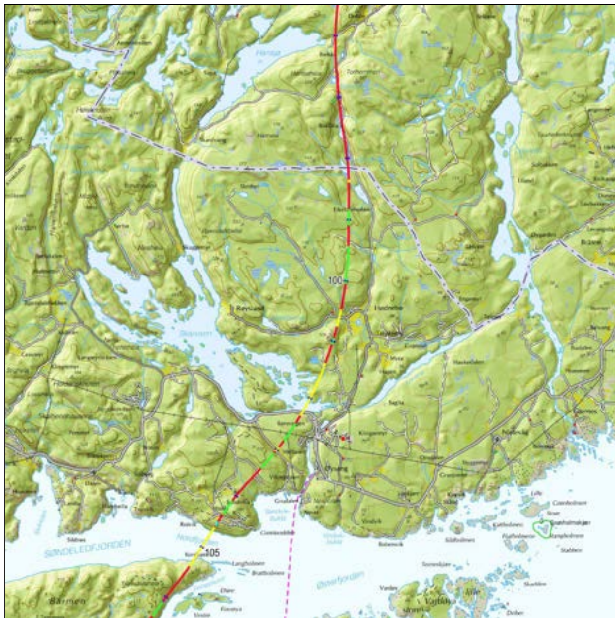
Detaljkart 13: Fra Porsgrunn til Risør, anbefalt trasé fra Buslåttdalen til Sønedeledfjorden. © Norsk Bane AS. Dagstrekninger er vist i rødt, broer i gult, kulverter i cyan og tunneler i grønt. Tunneler og broer på mindre enn 25 meters lengde er ikke inntegnet. Kilometerangivelsene (blå merker) viser distansen fra den nordre enden av forbindelsen mellom Vestlandsbanen og Grenland. Kartutsnittet er på 10 km x 10 km.
