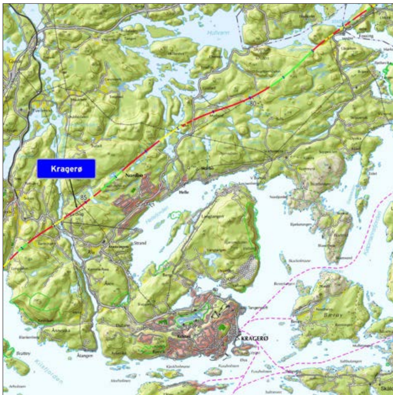
Detaljkart 11: Fra Porsgrunn til Risør, anbefalt trasé fra Fossing til Kilsfjorden. © Norsk Bane AS. Dagstrekninger er vist i rødt, broer i gult, overbygg i fiolett og tunneler i grønt. Tunneler og broer på mindre enn 25 meters lengde er ikke inntegnet. Kilometerangivelsene (blå merker) viser distansen fra den nordre enden av forbindelsen mellom Vestlandsbanen og Grenland. Kartutsnittet er på 10 km x 10 km.
