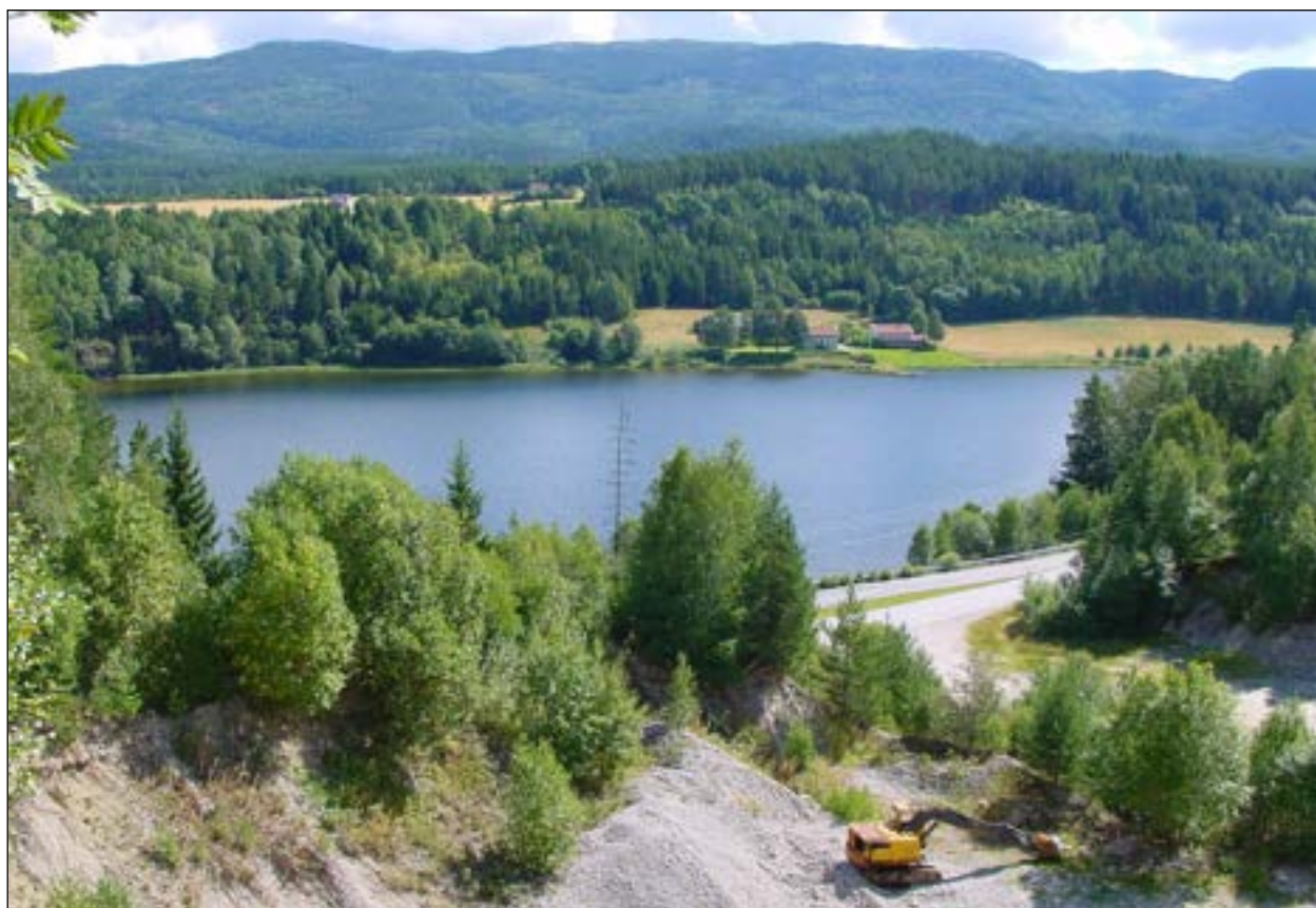
Bilde 10: Grustaket i framgrunnen viser at det er mye løsmasse nær Sauar-elva. En bro vil få best fundamenteringsforhold og bli kortest hvis den bygges ca. 500 m lenger sør, rettvisklet over elva til Sundshaugen (midt i høyre bildehalvdel). Farvollen sees på motsatt side av vassdraget; Sunde ligger utenfor høyre bildekant. Foto: © Norsk Bane AS.
