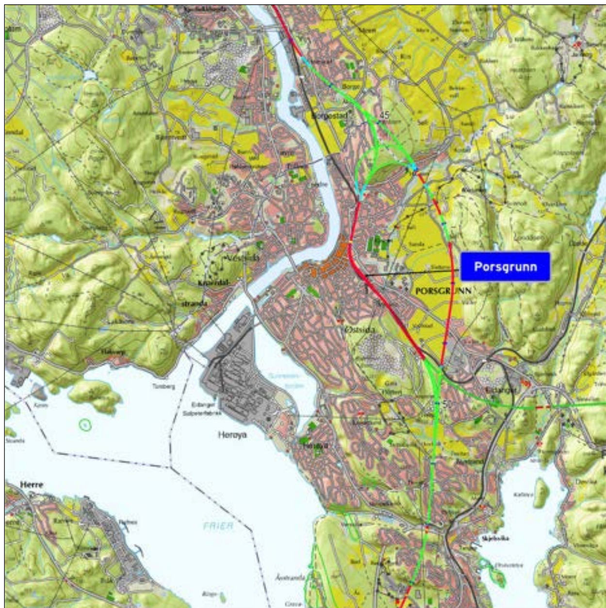
Detaljkart 7: Den planlagte stasjonen i Porsgrunn og tilgrensende banestrekninger. © Norsk Bane AS. Dagstrekninger er vist i rødt, broer i gult, tunneler i grønt og kulverter i cyan. Den nye banen fra Larvik er vist i en mørkere tone. Tunneler og broer på mindre enn 25 meters lengde er ikke inntegnet. Kilometerangivelsene (blå merker) viser distansen fra den nordre enden av forbindelsen mellom Vestlandsbanen og Grenland. Kartutsnittet er på 10 km x 10 km.
