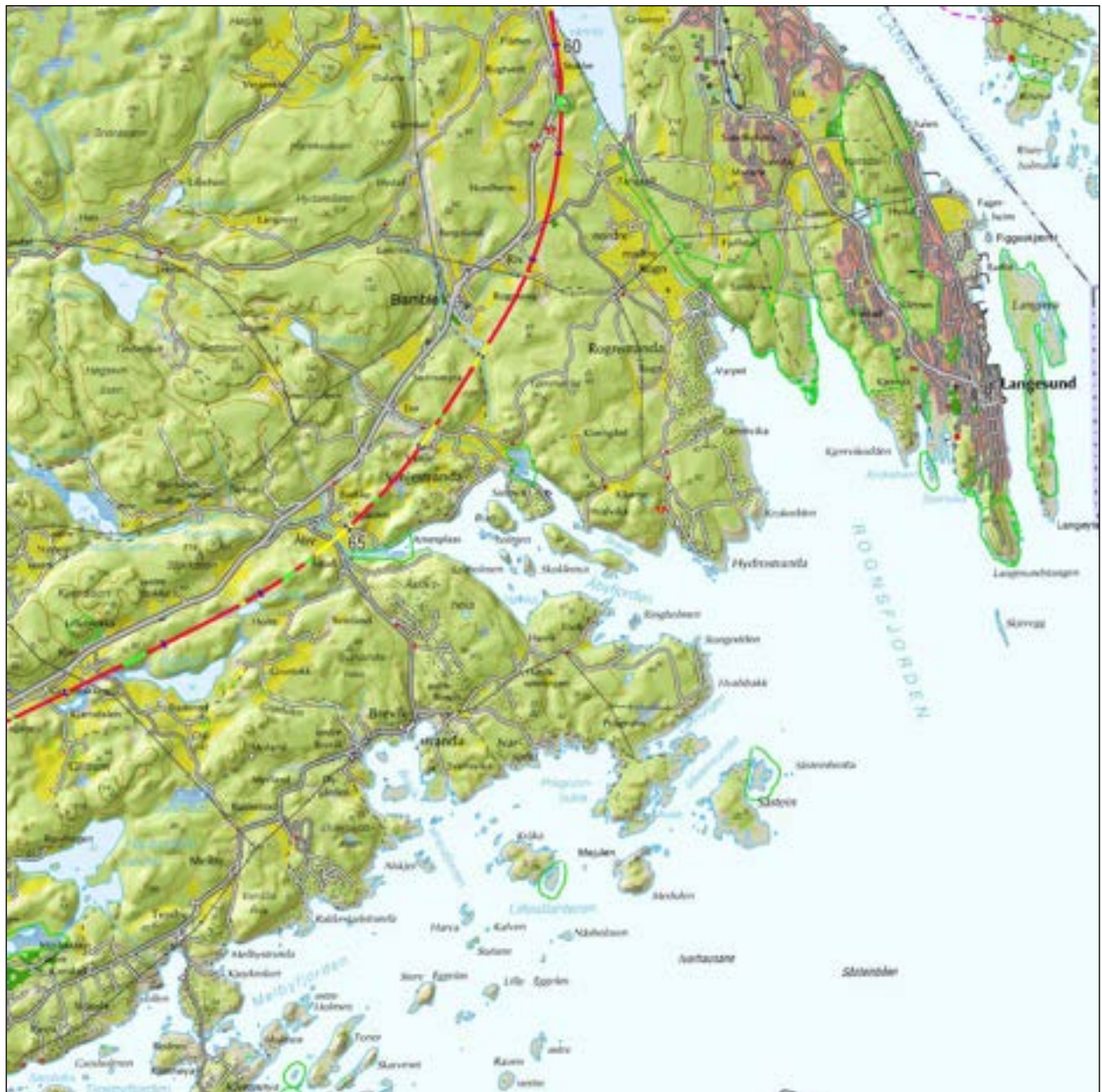
Detaljkart 9: Fra Porsgrunn til Risør, anbefalt trasé mellom Stathelle (like nord for øvre kartkant) og Kjær. © Norsk Bane AS. Dagstrekninger er vist i rødt, broer i gult og tunneler i grønt. Tunneler og broer på mindre enn 25 meters lengde er ikke inntegnet. Kilometerangivelsene (blå merker) viser distansen fra den nordre enden av forbindelsen mellom Vestlandsbanen og Grenland. Kartutsnittet er på 10 km x 10 km.
