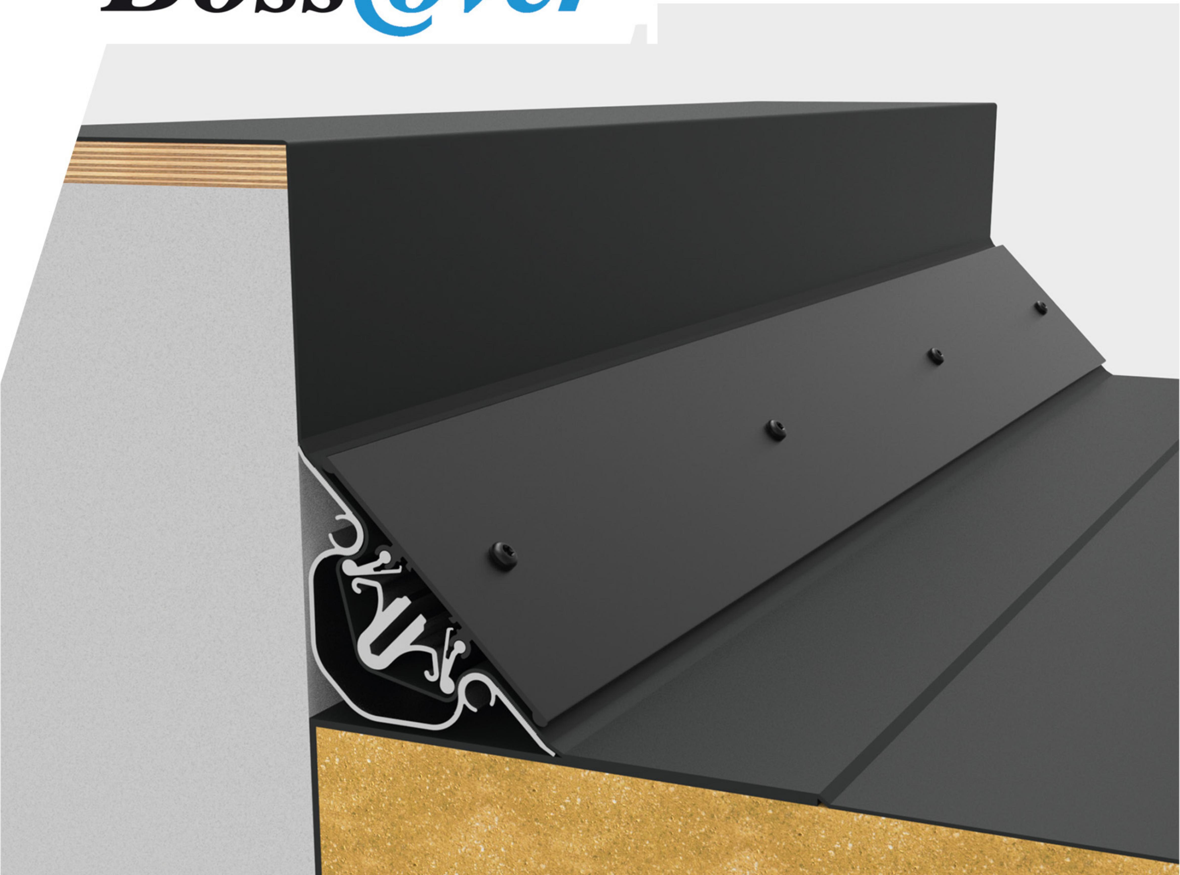
Lijmloos kimfixatiesysteem voor EPDM membraan
