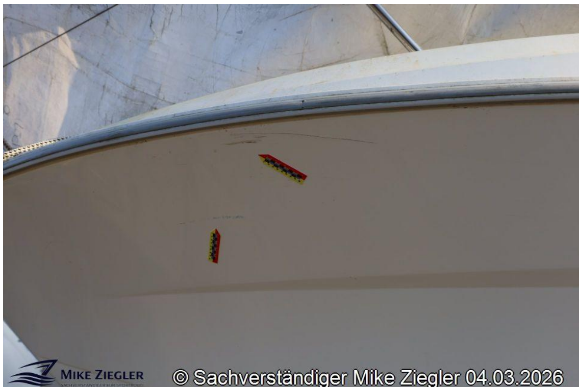
Foto 8: Detailansicht Altschaden Bugbereich Backbordseite
