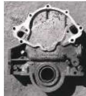
Corrosión ocasionada por el uso sólo de agua como refrigerante o una baja calidad del mismo.
