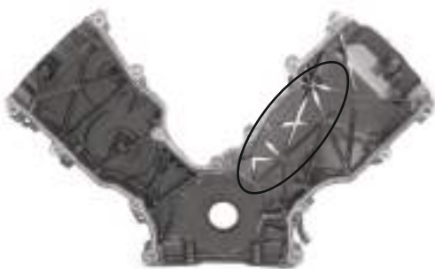
Desgaste por fricción de los componentes internos. (engranes o cadena de tiempo)
