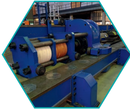
Endanschläge in großen Zugprüfmaschinen
