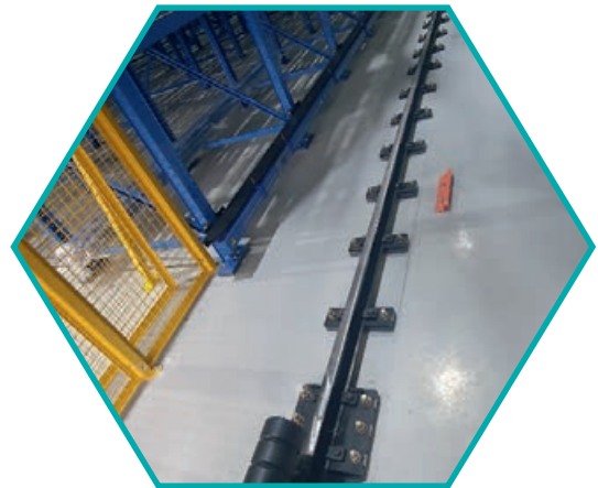
Endanschläge in automatischen Lagereinrichtungen
