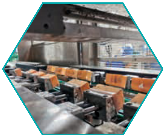
Guidage avec amortissement dans une installation d'emballage
