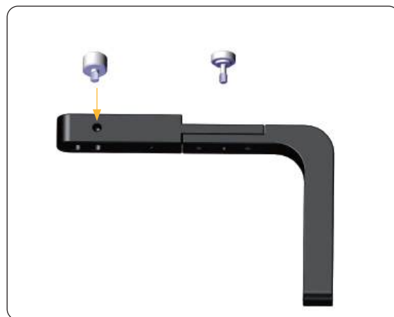
Fig. 30 Fixação do guia de broca
