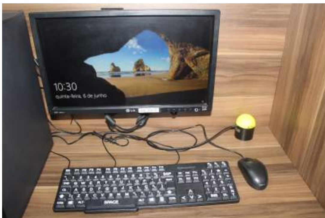
Computador com lupa, para usuários com baixa visão e teclado com letras ampliadas e sinalização em Braille
