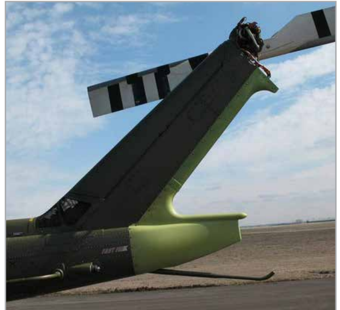
SUBARU BELL 412EPX Fast Fin® system
