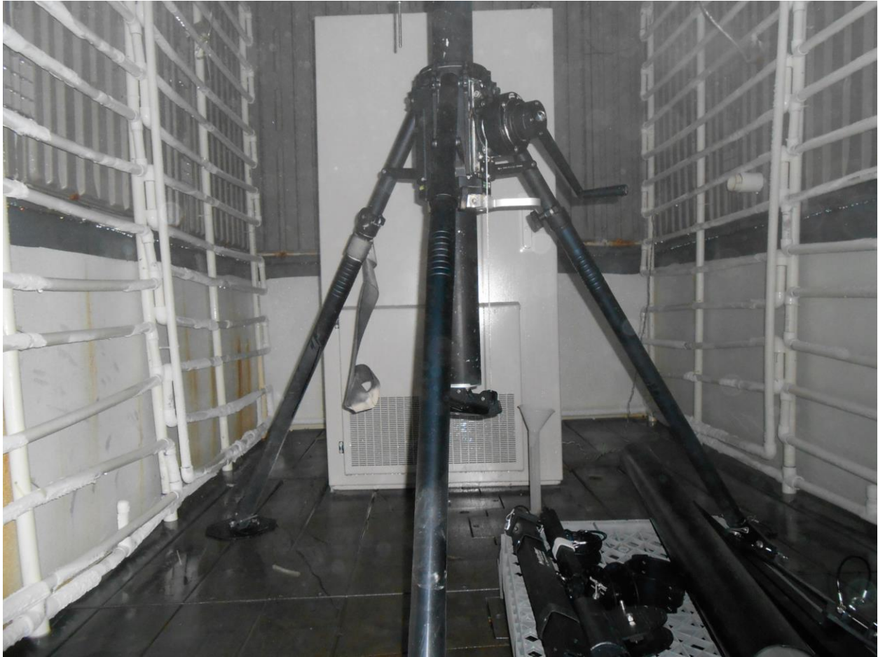
SALT FOG TEST SETUP
