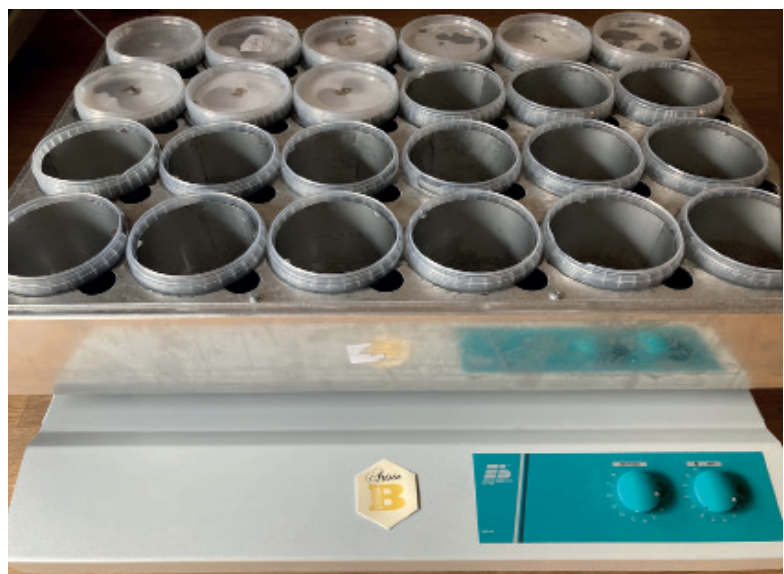
Figure 1 : Machine vibrante pour comptage des varroas phorétiques
