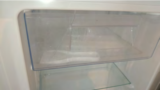
Sprekk i fryseskuff.
