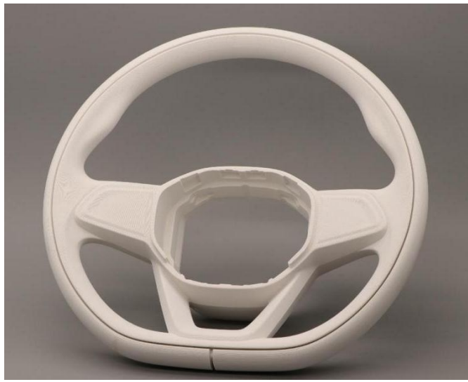
Graphique 3. Exemple de composants imprimés sur PC utilisés dans la fabrication industrielle haut de gamme
