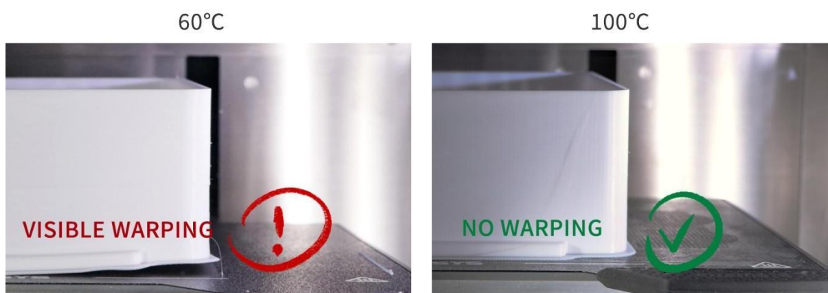
Graphique 5. Comparaison de la déformation d'une pièce PC à différentes températures de chambre
