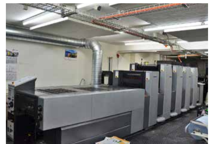
Vierfarben-Bogenoffsetmaschine mit Lackwerk und integrierter IR-Trocknung
