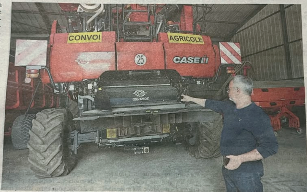
Éric Peschard a fait installer un matériel spécial sur sa moissonneuse-batteuse. Il permet d'identifier une partie des graines de mauvaises herbes pour les broyer et ainsi éviter leur germination.
