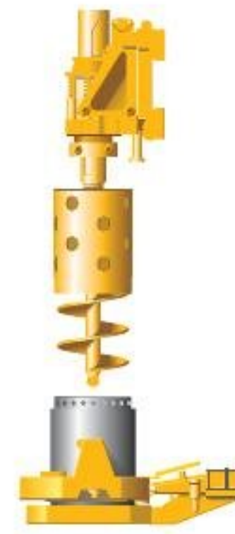
Verrohrtes Kellybohren Rohreinbau mit BV
