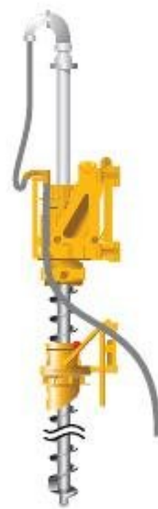
SOB Schneckenort- betonverfahren
