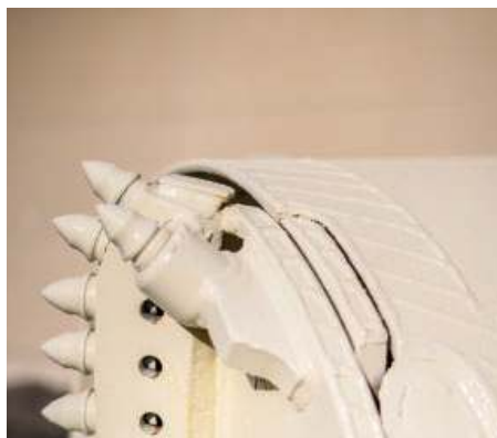
Kastenbohrer mit Auftragsschweißung Bucket with hard facing
