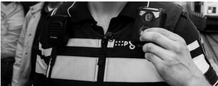
Figuur 3.6: Opname start door de knop op de voorzijde in te drukken; drie seconden ingedrukt houden stopt de opname
