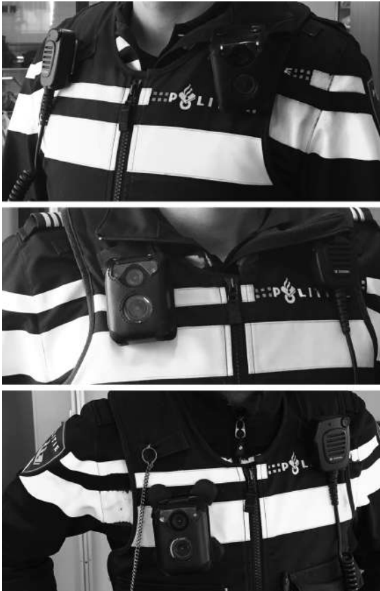
Figuur 3.7: Drie draagwijzen in een hoesje op het veiligheidsvest (van boven naar beneden): clip door lus, verlengde clip door lus en magneet
