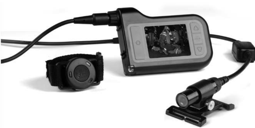
Figuur 3.2: De Zepcam T1: centrale unit (met beeldscherm en knoppen), camera en polsband
