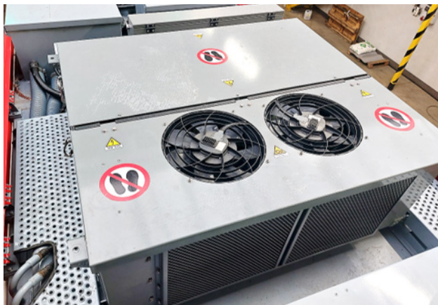
Die Klimaanlage ENIKA Quito bietet eine Kühlleistung von 17 kW und eine Heizleistung von 18 kW.
