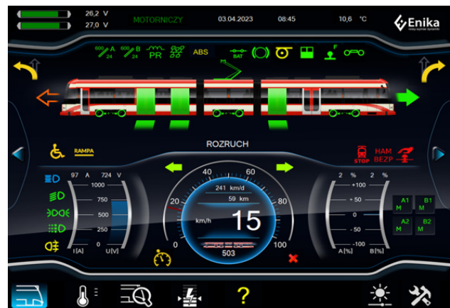
Beispiel der grafischen Benutzeroberfläche auf dem neuen Monitor im Fahrerstand.
