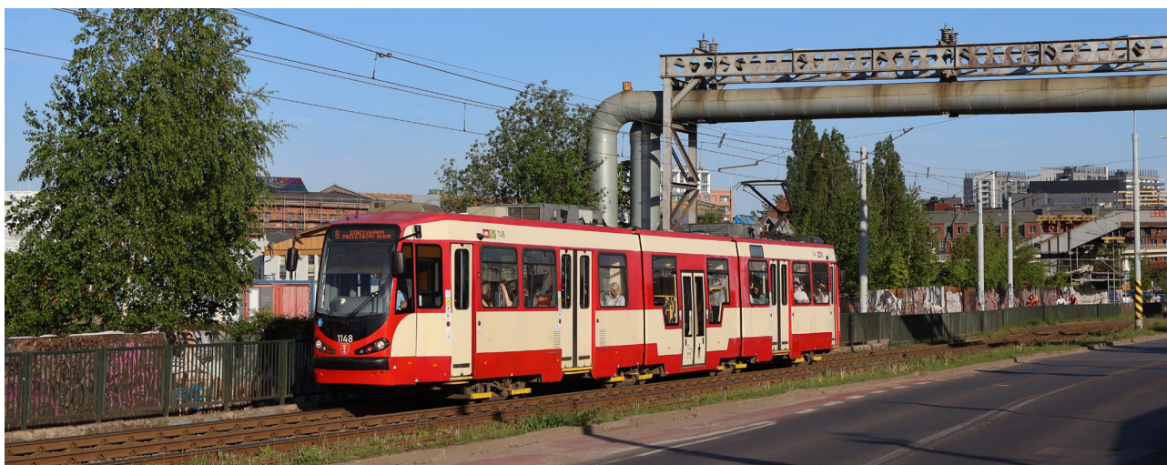
Teilniederflurige Straßenbahn des Typs Duewag N8C-MF 01 in Danzig mit elektrischer Ausrüstung von ENIKA.
