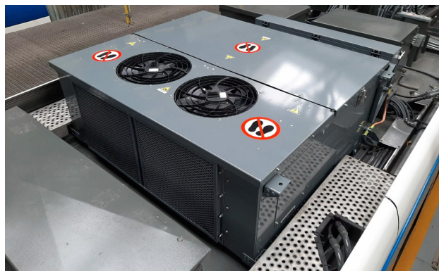
Klimaanlage QUITO 17AC/18DC auf einer NGT6-Straßenbahn in Krakau.
