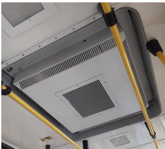
Beispiel für die Anwendung der iGORRA-Klimaanlage in einer Straßenbahn des Typs Protram 204WrAs.
