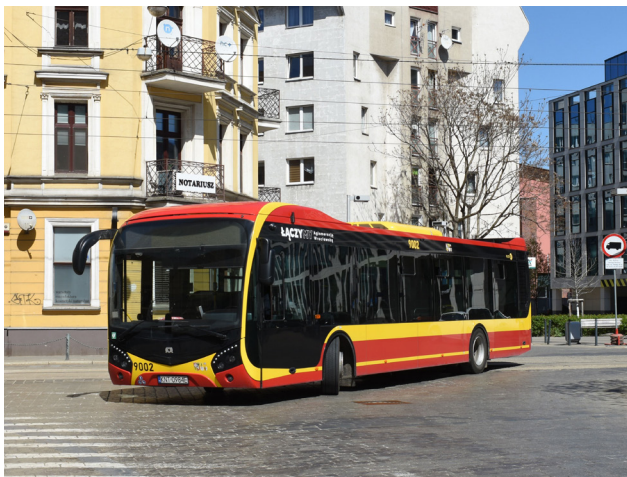
Autobus SOR NS 12 we Wrocławiu wyposażony w układ rekuperacji ENI-SBERS/20.
