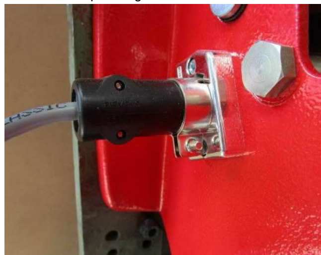
Ausbau der UV-Diode
