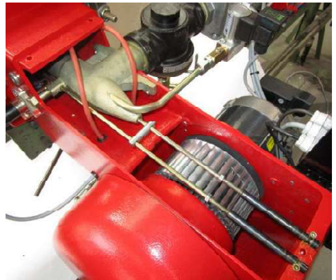
Ausbau des Gasdüsenstocks
