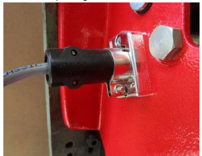
Ausbau der UV-Diode
