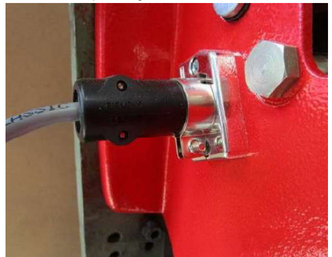
Ausbau der UV-Diode
