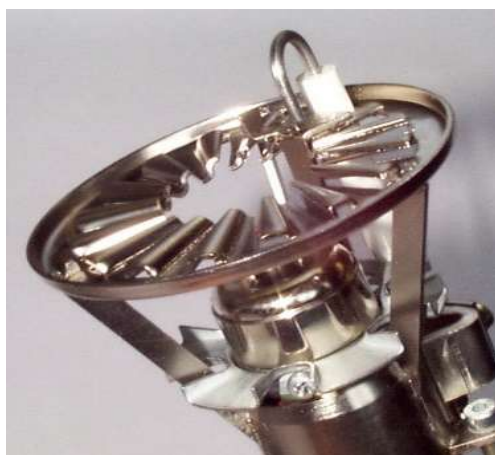
Fig. 29a Einstellen der Zündelektroden GZ/S 50 und 250
