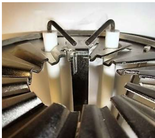
Fig. 29b Einstellen der Zündelektroden GZ/S 350 und 600
