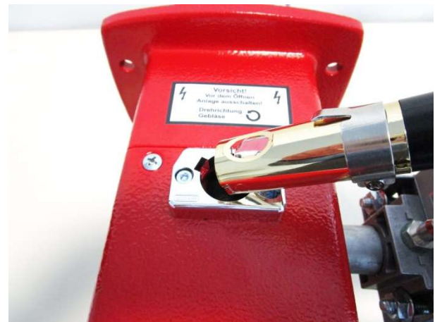
Ausbau der UV-Diode
