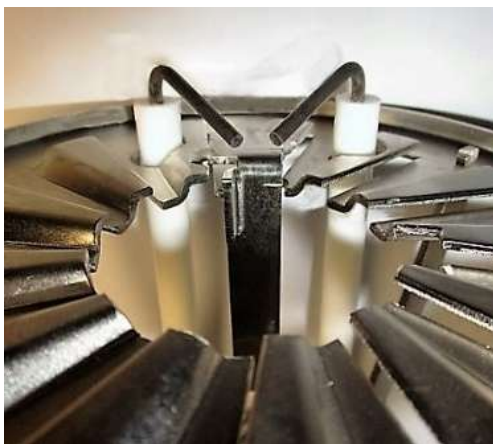
Fig. 29b Einstellen der Zündelektroden GZ/S 350 und 600
