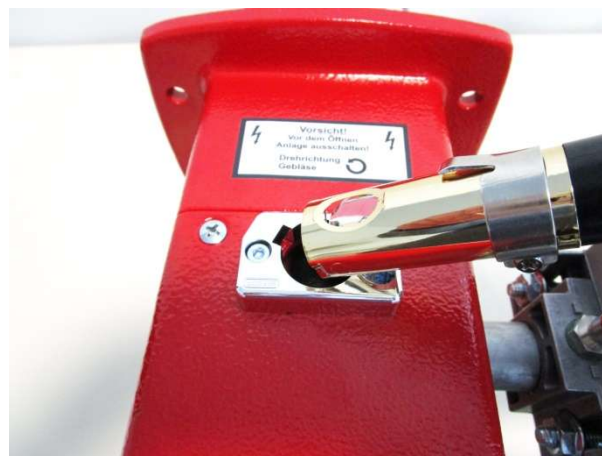
Ausbau der UV-Diode
