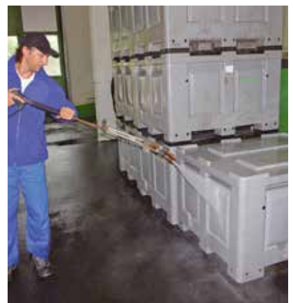
Die Halle ist mit einem Verrohrungssystem ausgestattet, das mehrere Abnahmestellen bietet. Dadurch benötigt der Mitarbeiter nur kurze Schlauchlängen für seine Arbeiten.
