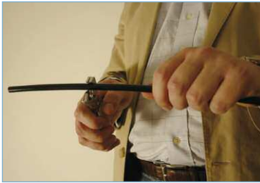
Polyamid-Rohrleitung auf die passende Länge schneiden
