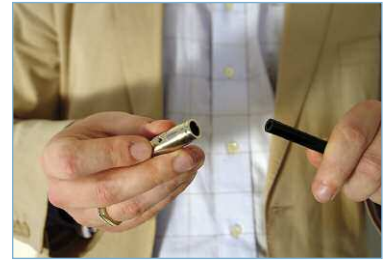
Leitung und Anschluss-Stück fest zusammendrücken
