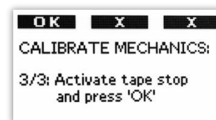
Abbildung 70 Kalibrierung Mechanik – Bremse aktivieren
