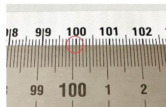
Abbildung 66 1m auf dem Referenzmaßstab ist 1mm kürzer als auf dem Maßband
