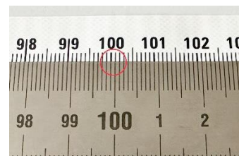
Abbildung 64 1m auf dem Referenzmaßstab ist 1mm länger als auf dem Maßband
