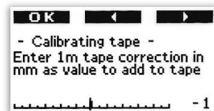
Abbildung 67 Anpassung -1mm im Kalibrierungsmenü
