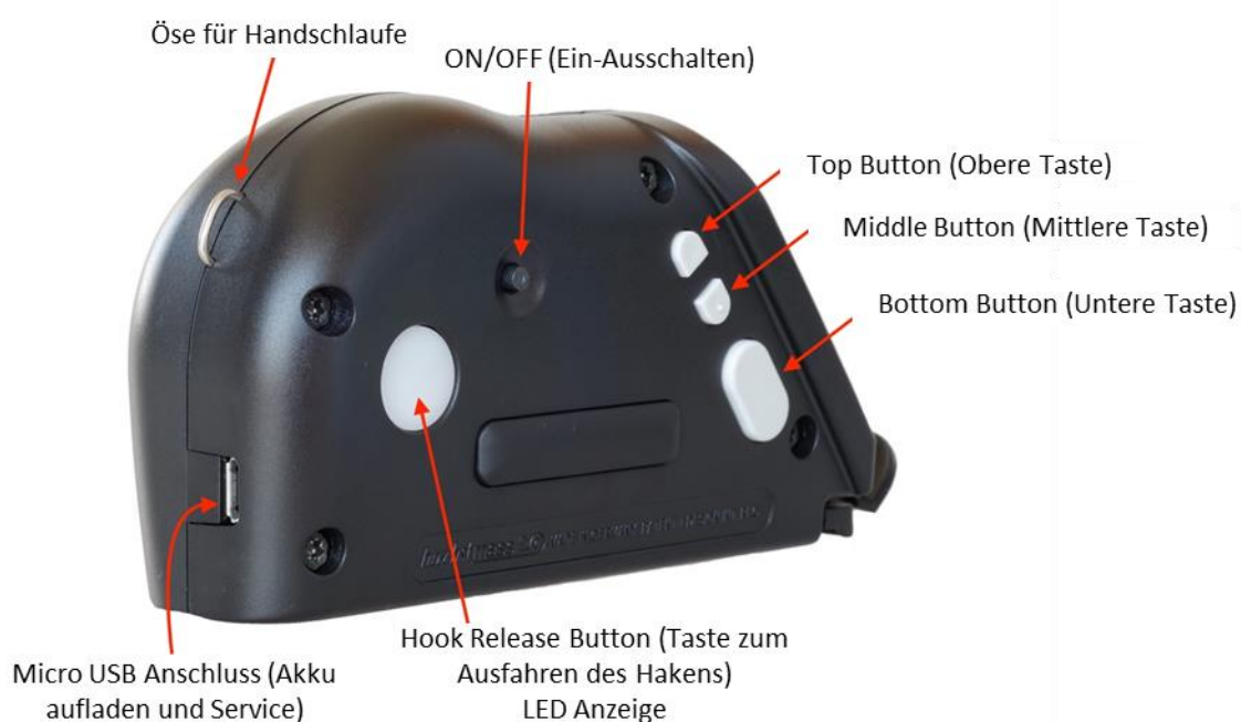
Abbildung 1 Tasten und Micro-USB Anschluss
