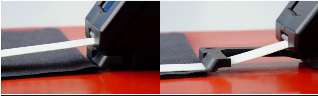
Abbildung 41 Messfehler durch zu großen Abstand
