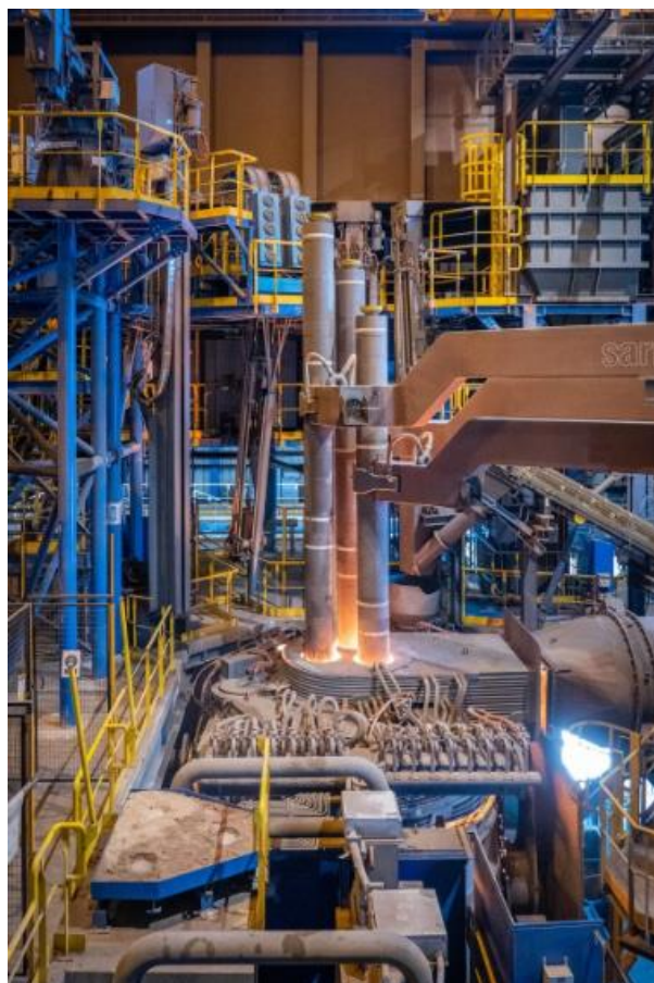
Four poche d'Arcelor Mittal à Fos-sur-Mer ©Arcelor Mittal
