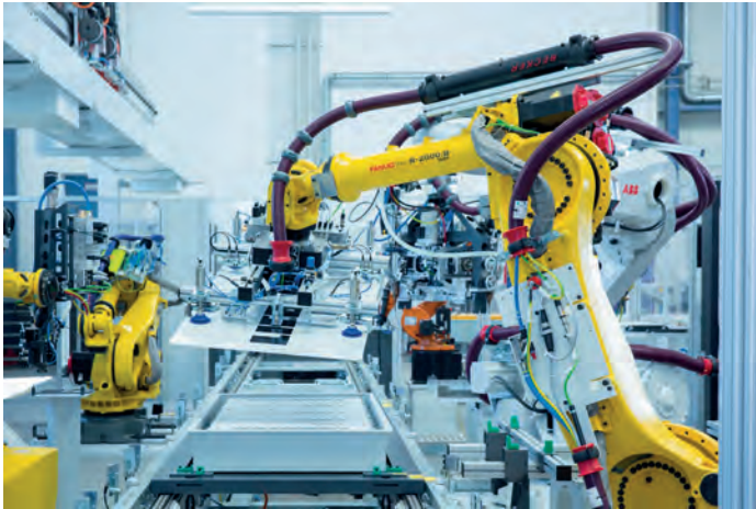
5 Module werden zum Pack montiert. Bild zeigt Aufsetzen des Gehäuseoberteils/Deckel und Verschraubung mit Batteriepackgehäuse. Quelle: Liebherr-Verzahntechnik GmbH
