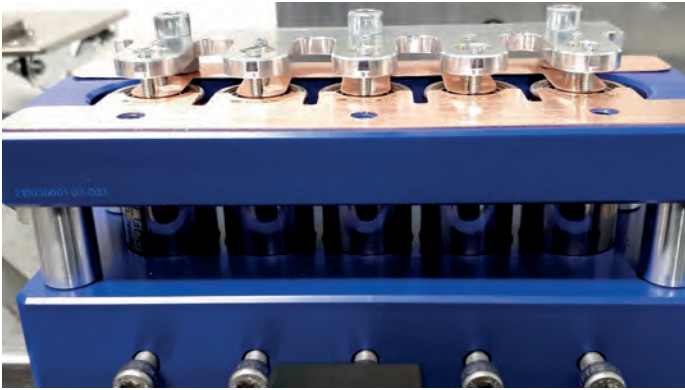
Ein aus zylindrischen Zellen und Busbar bestehender Batterieblock zur Untersuchung der Spanntechnik und Prozessparameter im Laserschweißen Quelle: PIA Automation Holding GmbH
