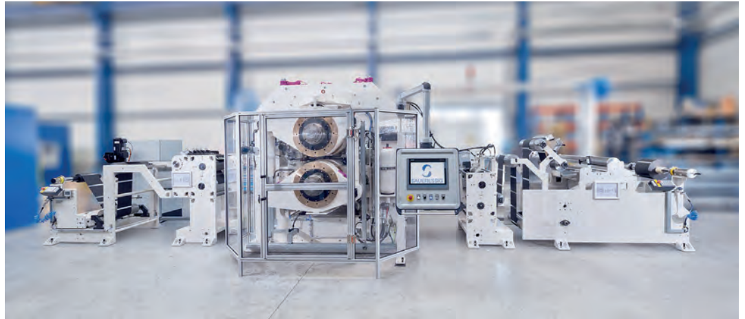
SAUERESSIG GKL 500 MS – Kalandersystem für intermittierend Beschichtete Elektroden Quelle: Matthews International GmbH
