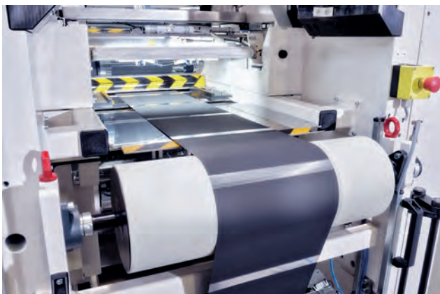
SAUERESSIG GKL 500 MS – Kalandersystem für intermittierend Beschichtete Elektroden (Detailaufnahme) Quelle: Matthews International GmbH
