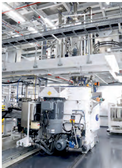
Vollautomatische 2 GWh Mischanlage für Beschichtungsmassen mit Eirich MixSolver® (links unten) und AZODOS® Dosieranlage (links oben) im UK Battery Industrialisation Centre (UKBIC) Quelle: AZO GmbH + Co. KG, Maschinenfabrik Gustav Eirich GmbH & Co KG
