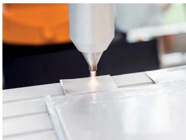
Plasmareinigung der Kontaktstelle einer Pouchzelle Quelle: Plasmatreat GmbH
