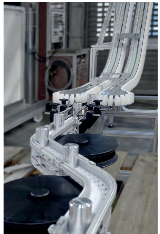
Fördersystem Versaflex für den ultra-schnellen Transport von Batterie-Rundzellen im Wareneingang eines Automobilherstellers – ohne Werkstückträger, mit maximalem Durchsatz und hoher Prozesssicherheit Quelle: Maschinenbau Kitz GmbH
