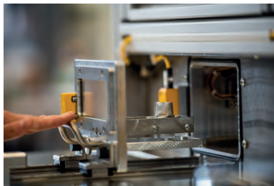
Electrolyte Jet: Semiautomatische Elektrolyt-Befüllmaschine für Pouchzellen mit Vakuumkammer Quelle: Industrie-Partner IP PowerSystems GmbH
